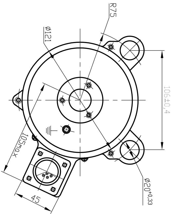
Вентильный электродвигатель постоянного тока. Применяется в качестве электропривода стиральных машин "Ось-автомат", а также приводов различных устройств с микропроцессорным блоком управления ВЭП-07.
